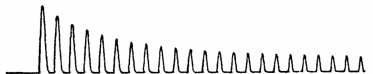
б) Типична форма на преходен ток на включване на трансформатор на празен ход
