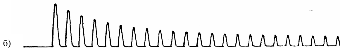
Типична форма на преходен ток на включване на трансформатор на празен ход
